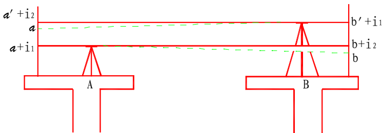
图 H.0.3 墩顶帽水准测量图
